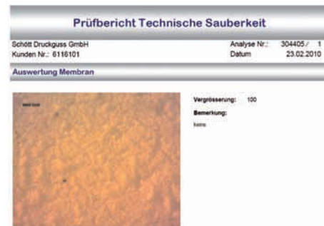
Bei der Teilesauberkeit wird eine maximale Partikelgröße von 200 µm gefordert
